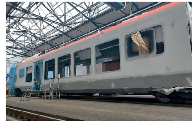
Nachdem wir in der letzten Ausgabe vom Projektstart „Redesign der Rheingaulinie“ berichtet haben, geht es diesmal um die neue Fahrzeuglackierung. Im ersten Schritt wurden die Wagenteile des ET409 getrennt, um die Wagenkästen später einzeln in der in Hagen installierten Lackierkabine bearbeiten zu können. Zuvor mussten noch Türblätter, Fenster mit Dichtungen und sämtliche äußeren Anbauteile demontiert werden. Zudem wurden alle Bekleibungen wie Logos und Anschriften sorgfältig entfernt.
